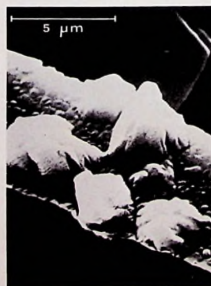
Bild 2. Schäden an einer Aluminium-Leiterbahn durch Materialtransport infolge hoher Stromdichte
